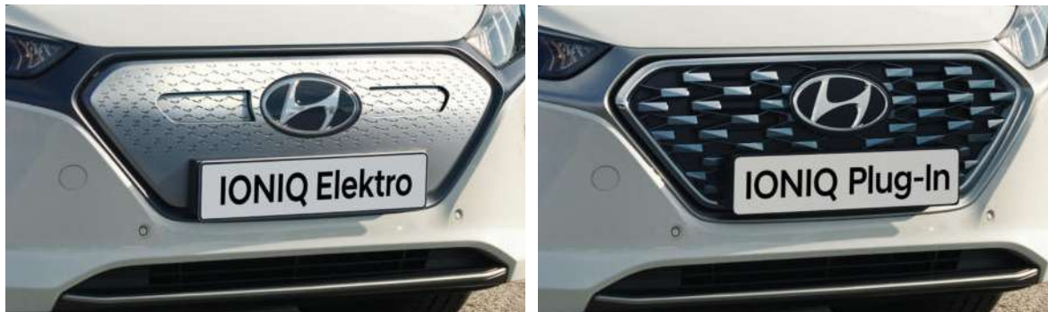
Im Kühlergrill integrierte Luftklappen öffnen und schließen sich automatisch, um die Aerodynamik und Kühlung bei allen Modellen zu optimieren.
